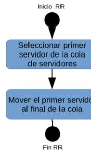
Figura 11. Diagrama de flujo del mecanismo RR
