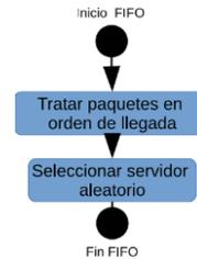
Figura 10. Diagrama de flujo del mecanismo FIFO
